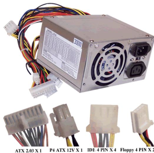
یک منبع تغذیه به همراه خروجی‌های متفاوت آن
