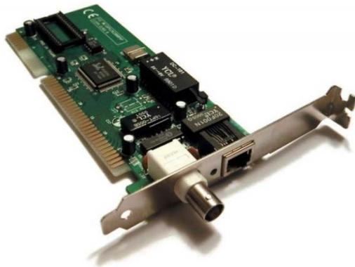
این کارت که به طور مستقیم بر روی برد اصلی نصب می‌شود، برای انتقال اطلاعات در شبکه‌های داخلی با سرعت بالا به کار می‌رود. این کارت نیز مثل مودم اطلاعات را روی کابل‌های شبکه‌ی قرار می‌دهد و یا برعکس، اطلاعات را از روی آن‌ها می‌خواند. بنابراین کارت شبکه هم یک دستگاه ورودی و هم یک دستگاه خروجی است.
