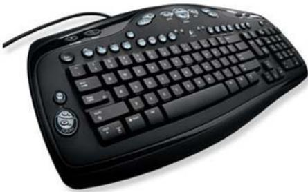
صفحه‌کلید مهمترین دستگاه ورودی کامپیوتر است. کاربر به کمک صفحه‌کلید می‌تواند اطلاعات را وارد کامپیوتر کند. دکمه‌های متفاوتی بر روی صفحه‌کلید وجود دارند که کاربردهای متفاوتی دارند. تعدادی از این دکمه‌ها برای وارد کردن حروف و اعداد هستند، برخی دیگر برای ویرایش متن، برخی برای محاسبات و کار با اعداد و تعدادی نیز کلیدهای کنترلی هستند. البته تعدادی کلید نیز در صفحه‌کلیدها وجود دارند که کلیدهای ترکیبی هستند و به تنهایی کار خاصی انجام
