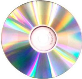
این نوع حافظه که شامل لوح‌های فشرده‌ی CD<sup>۱۶</sup> و DVD<sup>۱۷</sup> می‌شود، معمولاً برای ذخیره‌ی صوت و تصویر استفاده می‌شود. این دیسک‌ها قابل حمل هستند و برای جابجایی اطلاعات با حجم کم بکار می‌روند. بیشترین کاربرد این نوع از حافظه، جابجایی و نگهداری صوت و تصویر است.
